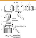
Anzugsdrehmoment für Klemmschraube Kontakteinsatz Pos. 5 mit Schraubkontakten beachten: • max. 0,1 Pm für Schraubkontakte Steckdurchmesser 1 mm • max. 0,2 Nm für Schraubkontakte Steckdurchmesser 2 mm
