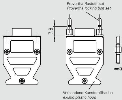
Variante E: Anbauset Verbindung Haube-Haube direkt durch Gehäusewand.
