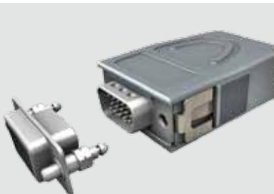
Das innovative Quick-Lock- System für D-Sub Steckverbinder von Provertha mit einem „Push-Pull“ Verriegelungssystem ermöglicht die einfach und schnelle Verriegelung von D-Sub Kabelsteckverbindern an D-Sub Geräteschnittstellen. Es können konfektionierte D-Sub Kabel mit der QuickLock Haube an schwer zugänglichen Einbauorten einfach und problemlos blind verriegelt werden. Das Verriegeln wird durch einen hörbaren „Click“ signalisiert.
