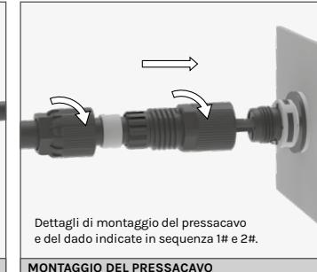
Dettagli di montaggio del pressacavo e del dado indicate in sequenza 1# e 2#.
