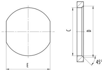
Mit Gewinde, einschraubbar/With thread to screw in
