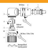
Anzugsdrehmoment für Klemmschraube Kontakteinsatz Pos. 5 mit Schraubkontakten beachten: • max. 0,1 Nm für Schraubkontakte Steckdurchmesser 1 mm • max. 0,2 Nm für Schraubkontakte Steckdurchmesser 2 mm
