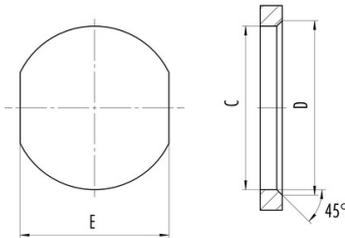
Mit Gewinde, einschraubbar/With thread to screw in
